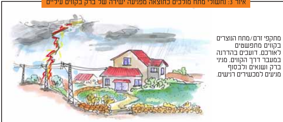
איור 3: נחשולי מתח מולכים כתוצאה מפגיעה ישירה של ברק בקווים עיליים
